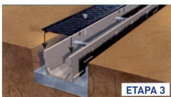
Montar las rejillas sobre los canales. verificar la alineación de los canales y su nivelación (el terreno adyacente al canal debe estar un mínimo de 3mm por encima de las rejillas. Proteger las rejillas con un film plástico.
